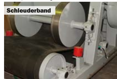
Anwendung: Schüttgut wird in die Ecken des Laderaums geschleudert
