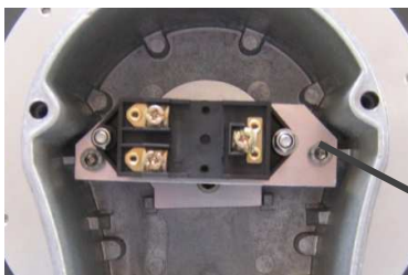
Stellschraube zum Justieren vom Schaltpunkt
