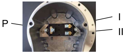
Elektrische Kontakte bei unbelasteter Membran:
